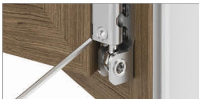
Posibilidad de ajuste de la presión en la bisagra inferior de la hoja en un rango de +/- 0,8 mm.
