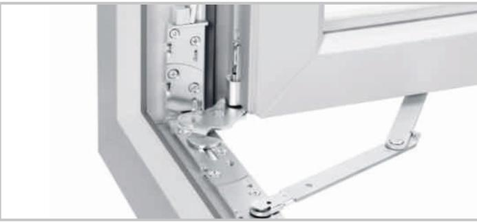
Herraje oscilo-batiente totalmente oculto con un diseño elegante. La ausencia de bisagras visibles convierte la ventana en parte de un interior refinado. El innovador sistema oscilobatiente permite utilizar con seguridad las hojas con un peso 150 kg. El herraje activPilot Select permite que la ventana no se abra más de 95°, protegiendo los marcos o los muebles de posibles golpes.
