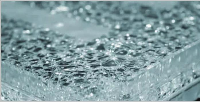
**TRIPLEX** es un tipo de vidrio laminado de seguridad, compuesto por varias capas de vidrio unidas mediante una lámina polimérica. En caso de impacto mecánico, el vidrio no se rompe en fragmentos, sino que se agrieta, manteniendo la integridad del conjunto. Esto es posible gracias a la capa polimérica que mantiene unida la superficie de vidrio.
