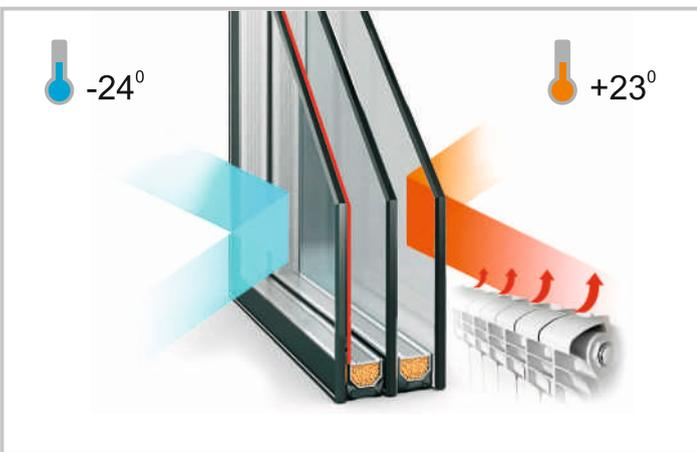
**VIDRIO DE AHORRO ENERGÉTICO.** Es un vidrio cuya superficie se recubre mediante un proceso de deposición al vacío con una capa reflectante suave, casi invisible (con plata o titanio). Gracias a esto, el vidrio actúa como un espejo térmico, reflejando las ondas térmicas largas de los dispositivos de calefacción de vuelta al interior de la vivienda. El doble acristalamiento con vidrio de bajo consumo energético es entre un 30-50% más cálido que el vidrio convencional.
