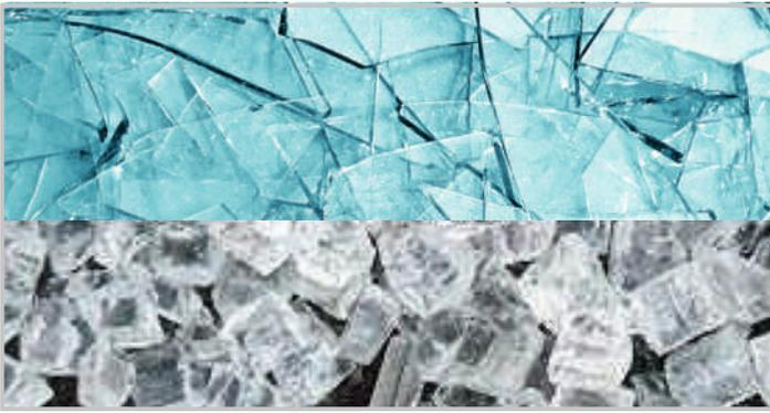
**VIDRIO TEMPLADO** se obtiene mediante el calentamiento a temperaturas de templado (650–680 °C). Es hasta 6 veces más resistente que el vidrio convencional. Resistente a altas temperaturas y a cambios térmicos extremos. En caso de rotura, el vidrio templado se fragmenta en múltiples piezas pequeñas que no representan un peligro grave.
