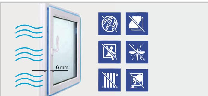
Microclima natural y eficiencia energética. Las ventanas con herraje activPilot Comfort permiten reproducir la circulación natural del aire en la habitación. El flujo de aire fresco se logra mediante el desplazamiento uniforme de la hoja 6 mm a lo largo de todo el perímetro. La ventilación con activPilot Comfort evita la formación de condensación y moho, previene el enfriamiento rápido y reduce al mínimo la pérdida de energía. Nivel de seguridad europeo Rc2.
